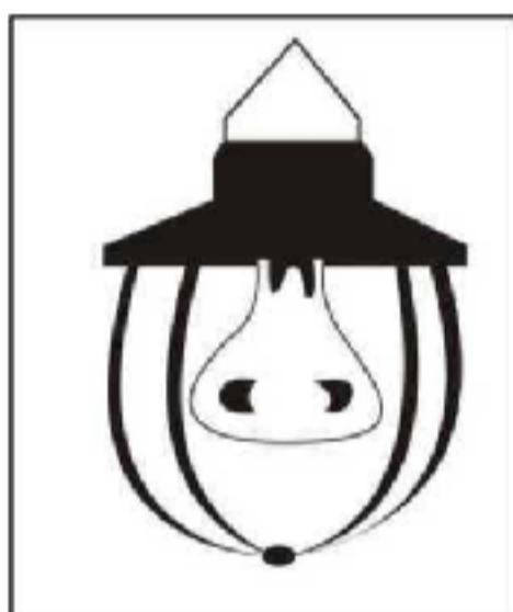
Обігрівальний пристрій з лампою інфрачервоного випромінювання ІКЗК -250
